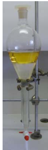
Démixion dans une ampoule à décanter
